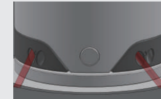
2つの赤外線LEDと2つのリニアイメージセンサを使ってエンドグループの位置変化を検出する
