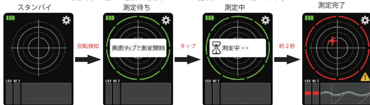
※偏心測定する際は必ずターンテーブルを (33 回転 or 45 回転) 回転させてください。
