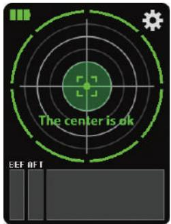
絶対的中心位置に回転中心が合つたら再度レコードプレーヤーを回転させてレコードを再生してください。偏心量が  $20\mu$  以下となると左図のような The center is ok という表示に切り替わります。レコード再生を始めるとスタビライザーの電源は自動で切れます。
