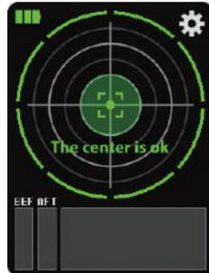
絶対的中心位置に回転中心が合ったら再度レコードプレーヤーを回転させてレコードを再生してください。偏心量が  $20\mu$  以下となると左図のような The center is ok という表示に切り替わります。レコード再生を始めるとスタビライザーの電源は自動で切れます。
